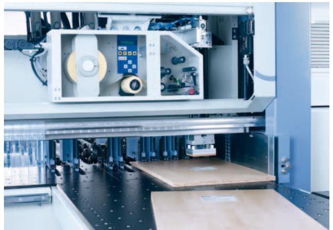
▲ Automatische Etikettierung am Druckbalken an der installierten Plattensäge HPP 380 profilLine
