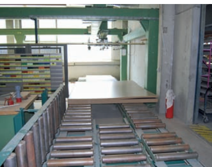
Flexible Materialversorgung: liegendes Lager für Rohformatplatten vor der Nesting-Maschine
