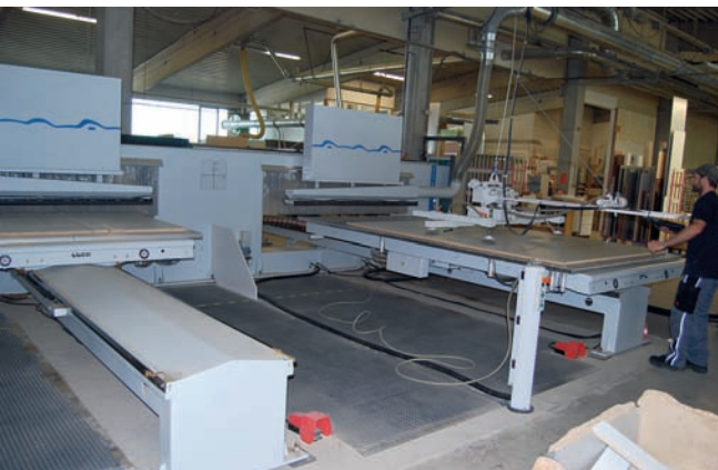
Das Herzstück der neuen Fabrik in der Fabrik: das für das Nesting konzipierte Bearbeitungszentrum Optimat BOF 611 von Homag
