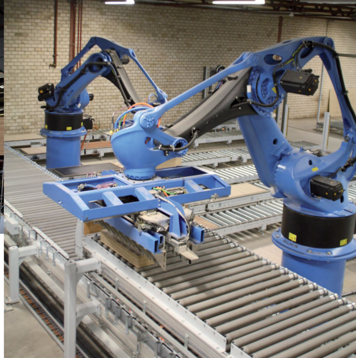
>Den Automatisierungsgrad und die Flexibilität erhöhen, die Personalkosten reduzieren – dies waren einige der Ziele, die die Recor-Gruppe mit der Umgestaltung ihrer Kastenmöbel-Fertigungslinie erreichen wollte. Die Abstapelung nach der Holzma-Säge ist bislang einmalig in ihrer Ausführung.
